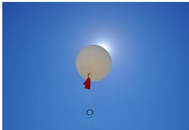
Durante la sua ascensione ha consentito di rilevare e trasmettere a terra una serie di parametri atmosferici( temperatura, umidità, pressione, direzione e intensità del vento e quant'altro) di fondamentale importanza per conoscere il profilo verticale dell'atmosfera e concorrere a fornire i dati indispensabili per la formulazione delle Previsioni del Tempo.
